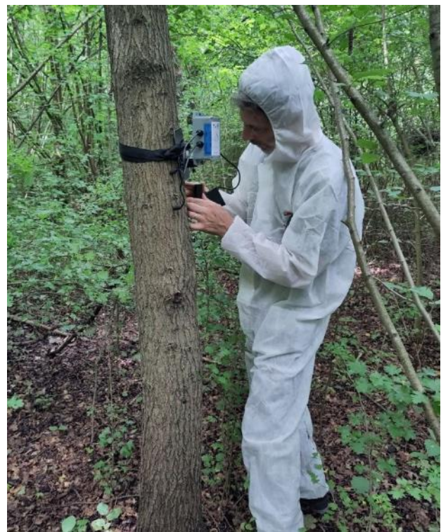
Figura 20. Messa in opera TT+: inserimento sonde e sensori nel tronco. Bosco Belvedere, 31/07/2023 (foto: S.M. Preo)
